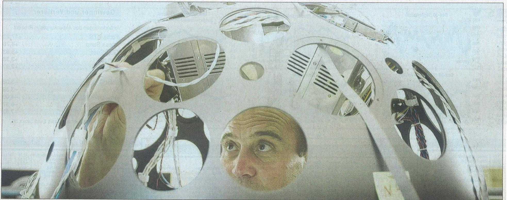
Produktion bei Zeiss in Jena: Sternenkugel für einen Planetariumsprojektor. Mit mehreren Standbeinen sieht sich der Konzern gut aufgestellt
